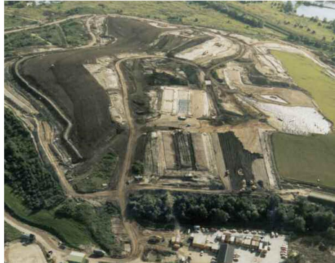
*Die Mülldeponie Georgswerder während der Sanierung. Vorn im Bild erkennt man den „Betriebshof“ mit den Einrichtungen für die Projektleitung, Lagerung von Geräten und Material sowie Parkplätzen für die Mitarbeiter. Der Platz mit seinen Gebäuden wurde eigens für die Sanierung errichtet.*
