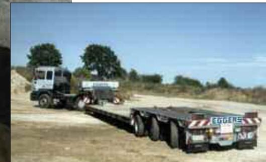
Tieflader, MAN Lkw (480 PS) mit Scheuerle-Tieflader, 19,90 m lang, 3,50 m breit bei Ausnahmegenehmigung, 32 t Nutzlast.
