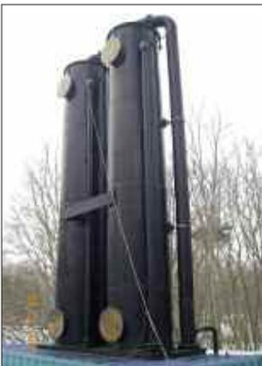
Stripanlage zur Abtrennung von Schadstoffen.
