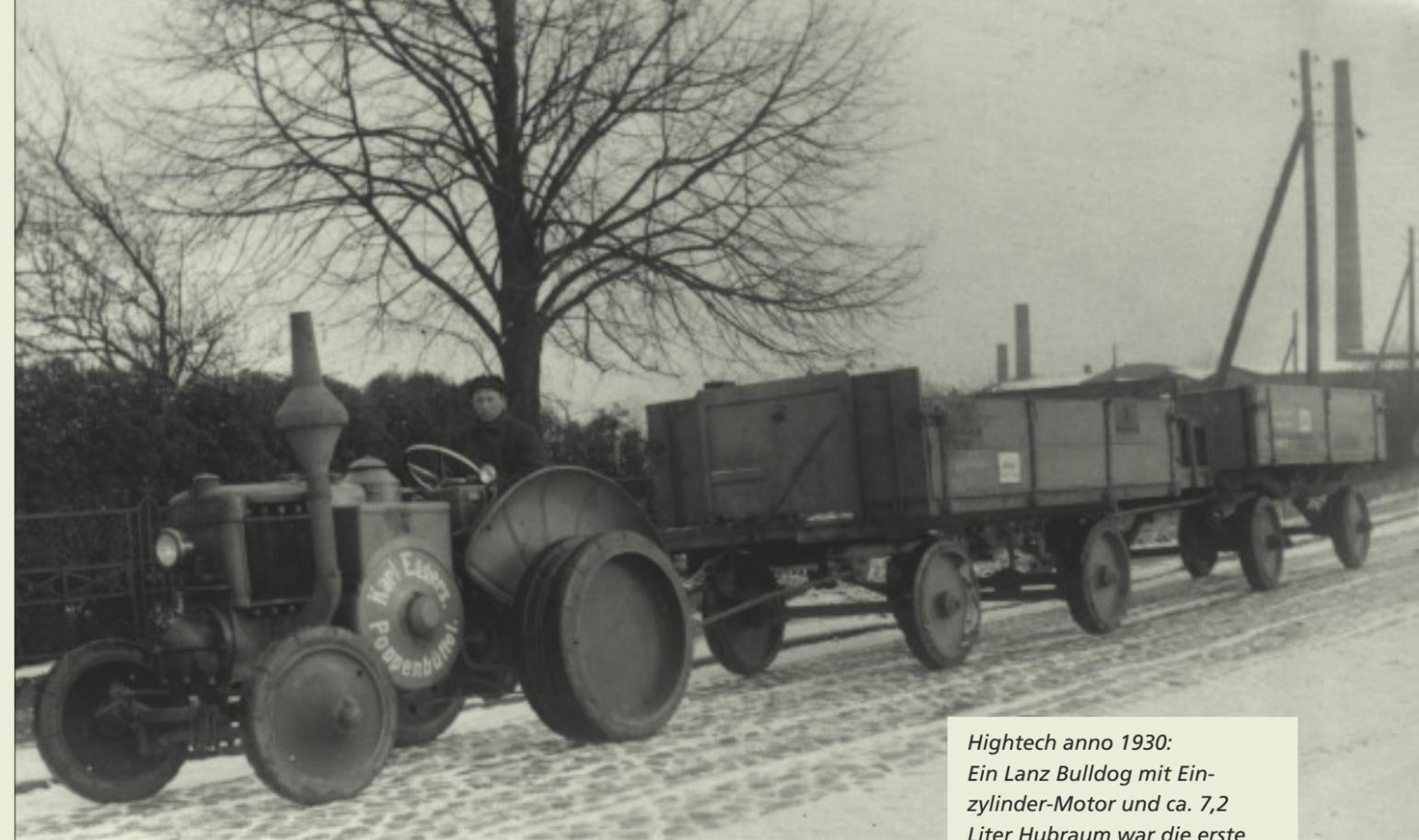
Hightech anno 1930: Ein Lanz Bulldog mit Einzylinder-Motor und ca. 7,2 Liter Hubraum war die erste Zugmaschine, mit der Eggers Sand und Kies transportierte. Der Bulldog war äußerst robust und wurde mit Rohöl betrieben.
